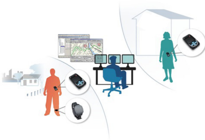
Esquema de monitoração eletrônica de pessoas em situação de violência doméstica – Fonte: Spacecom Monitoramento S/A.
